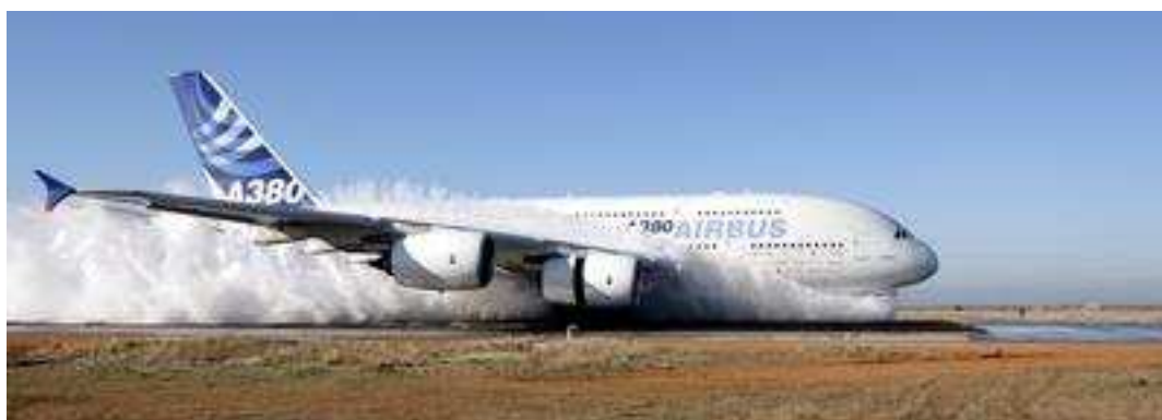
Essai Piscine de l'A380 (© Airbus)
