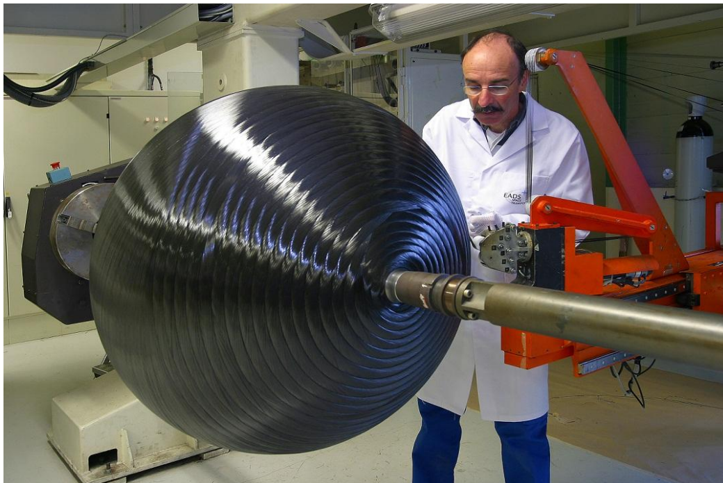
Opération de bobinage d'une sphère haute pression (Avec l'aimable autorisation d'Astrium)
