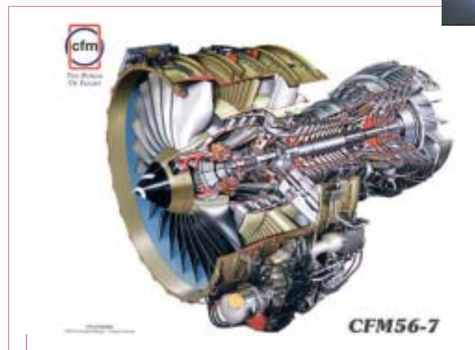
■ Ecorché du moteur CFM56-7 de Snecma-Moteurs
